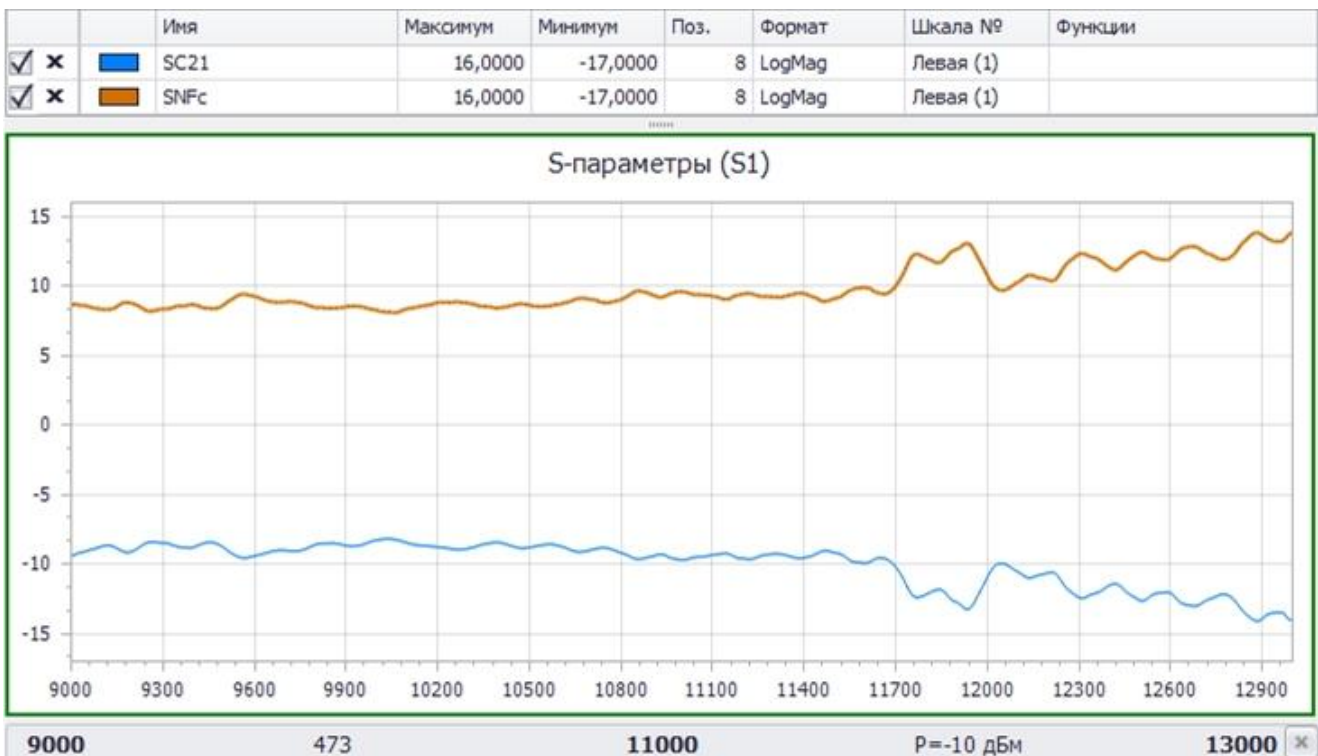
Рис. 16. Результаты измерения коэффициента преобразования и коэффициента шума смесителя «Marki microwave» M20026LA
