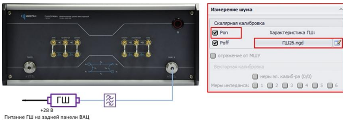
Рис. 14. Подключение генератора шума ко второму порту ВАЦ, через фильтр. Калибровка ВАЦ для измерения коэффициента шума.
